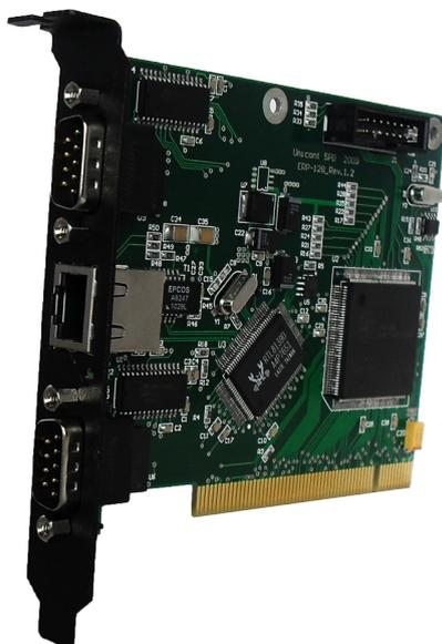
Расширитель портов ERP-128 предназначен для увеличения числа портов компьютера типа COM (RS232, RS422) и Ethernet через шину PCI. (Плата не предназначена для самостоятельного использования, используется только в составе с компьютером).
