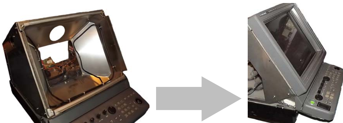
Рисунок 12. Установка дисплея в стойку РЛС
