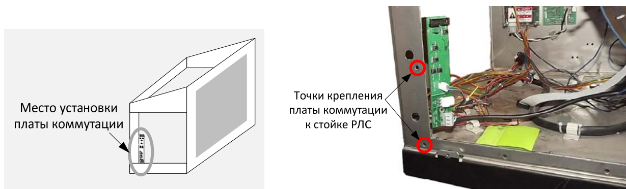
Рисунок 13. Место установки платы коммутации (слева), общий вид платы коммутации в стойке РЛС (справа)
