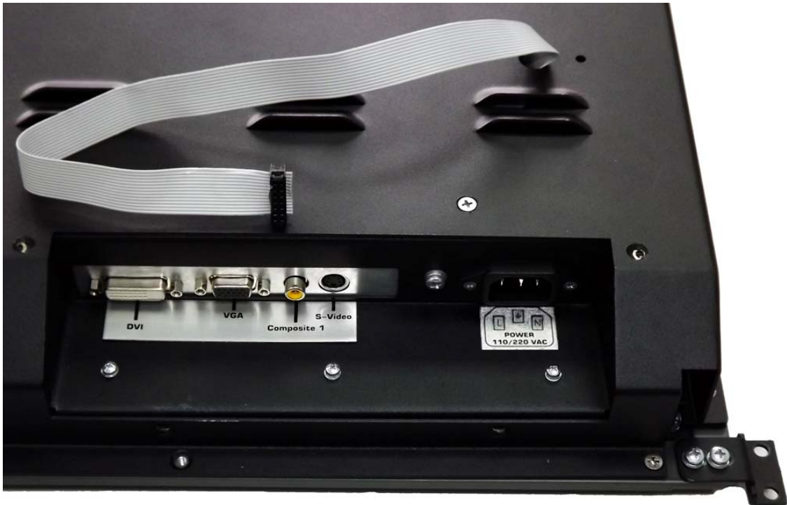
Рисунок 14. Расположение разъемов и кабеля управления ЖК-дисплея
