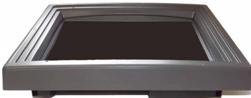
Рисунок 11. Внешний вид подготовленного к установке ЖК-дисплея вмонтированного в рамку ЭЛТ
