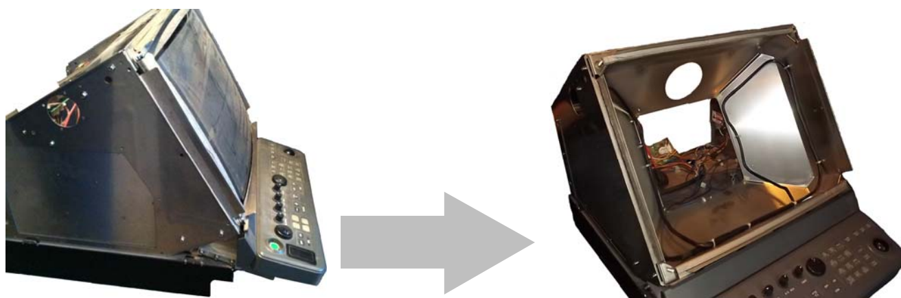
Рисунок 5. Демонтаж ЭЛТ из стойки РЛС
