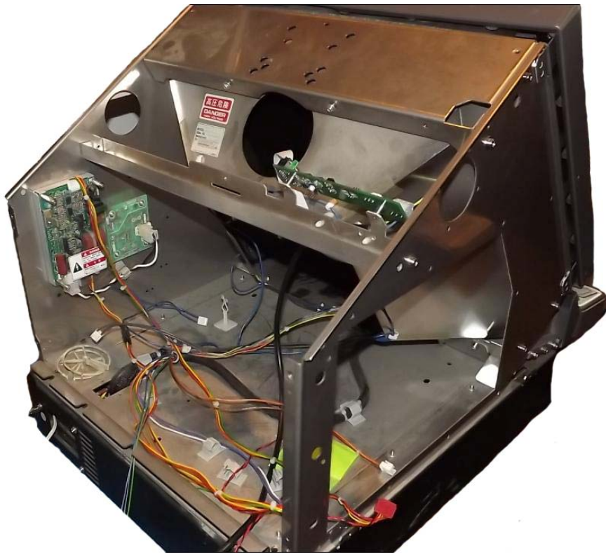
Рисунок 2. Общий вид стойки освобожденной от блока развертки и прочих устройств
