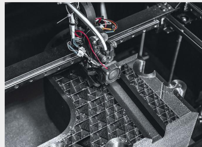
Если точность FDM- или FGF-печати оказывается недостаточной, по её окончании производится фрезерная обработка изделия — сперва грубая, потом точная, способная обеспечить точность до 50 микрон.
