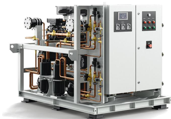
ЗАКК оснащаются всеми необходимыми трубопроводами, датчиками защиты и автоматики, арматурой, кабельными вводами, бонками заземления, регуляторами давления конденсации, счетчиками наработки компрессоров. Для охлаждения агрегатов используется забортная или пресная вода.
