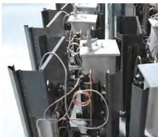
Установки термостатирования UNICOOL UTS предназначены для автоматического поддержания заданных параметров охлаждающей жидкости в интервале температур от  $-5\text{ }^{\circ}\text{C}$  до  $+25\text{ }^{\circ}\text{C}$  и отведения тепловой нагрузки от обслуживаемых объектов.
