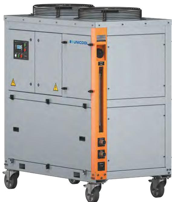
Установки могут иметь встроенный бак-аккумулятор объемом 140 л (ёмкость может быть увеличена по требованию заказчика) либо встроенный гидромодуль из одного или двух высоконапорных насосов. Могут оснащаться роликовыми колесами для перемещения либо жёстко монтироваться на фундаменте. Обслуживание фильтра производится с задней стороны.
