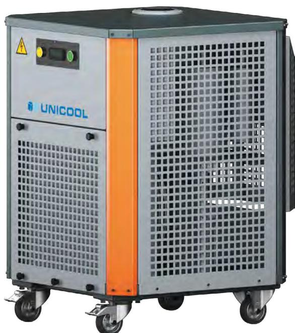
Установки могут иметь встроенный бак-аккумулятор объемом 20 л и высоконапорный насос. Компактность конструкции позволяет перемещать установку на роликовых опорах. Обслуживание фильтра производится с фронтальной стороны.
