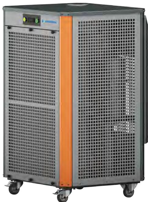
Установки могут иметь встроенный бак-аккумулятор объемом 50 л и высоконапорный насос. Компактность конструкции позволяет перемещать установку на роликовых опорах. Обслуживание фильтра производится с фронтальной стороны.
