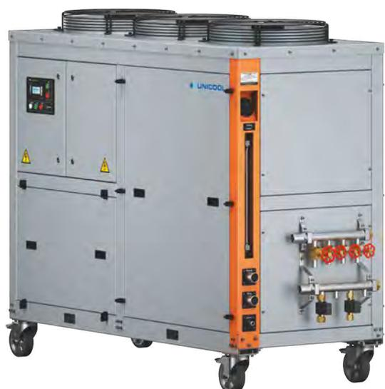
Установки могут иметь встроенный бак-аккумулятор объемом 230 л (ёмкость может быть увеличена по требованию заказчика) либо встроенный гидромодуль из одного или двух высоконапорных насосов. Могут оснащаться роликовыми колесами для перемещения либо жёстко монтироваться на фундаменте. Обслуживание фильтра производится с задней стороны.
