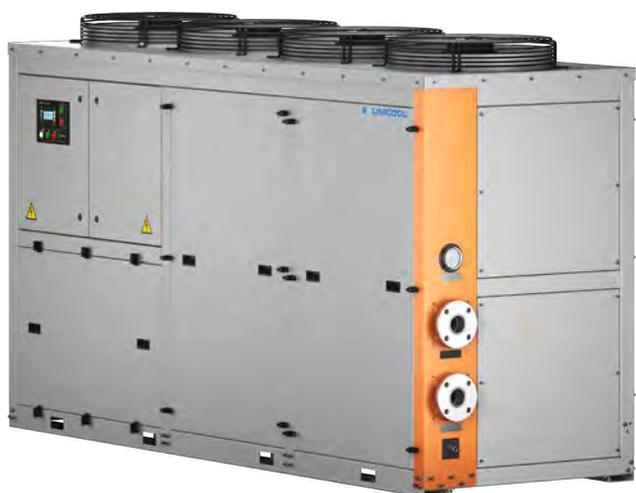
Установки могут иметь встроенный бак-аккумулятор объемом 800 л (ёмкость может быть увеличена по требованию заказчика) либо встроенный гидромодуль из одного или двух высоконапорных насосов. Жёстко монтируются на фундаменте. Обслуживание фильтра производится с задней стороны.
