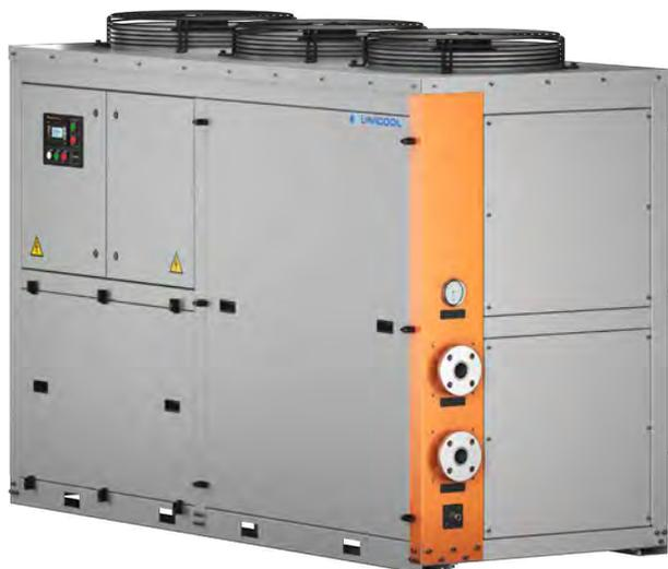
Установки могут иметь встроенный бак-аккумулятор объемом 500 л (ёмкость может быть увеличена по требованию заказчика) либо встроенный гидромодуль из одного или двух высоконапорных насосов. Жёстко монтируются на фундаменте. Обслуживание фильтра производится с задней стороны.
