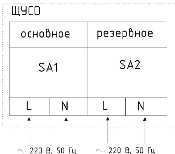
Рисунок Б.1 – Схема подключения ЩУСО к основному и резервному питанию
