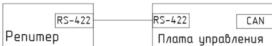
Рисунок Б.3 – Схема подключения одного ПОА по RS-422
