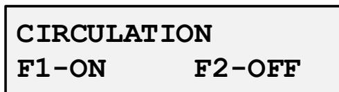
Рисунок 15 – Внешний вид ЖК-дисплея изделия с отображением включения (выключения) имитации циклического поворота судна
