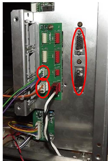
Рисунок 1 – Расположение разъемов блока развертки (слева), общий вид блока развертки с подключенными кабелями (справа)
