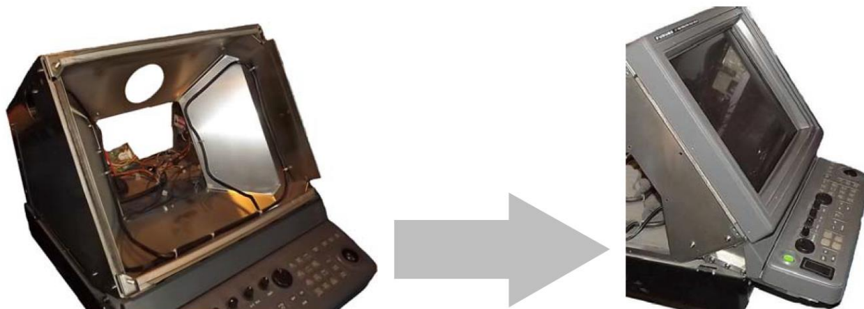
Рисунок 12 – Установка изделия в стойку РЛС
