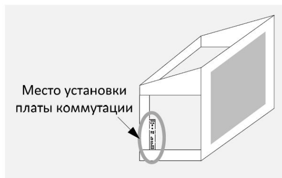
Рисунок 13 – Место установки платы коммутации (слева), общий вид платы коммутации в стойке РЛС (справа)
