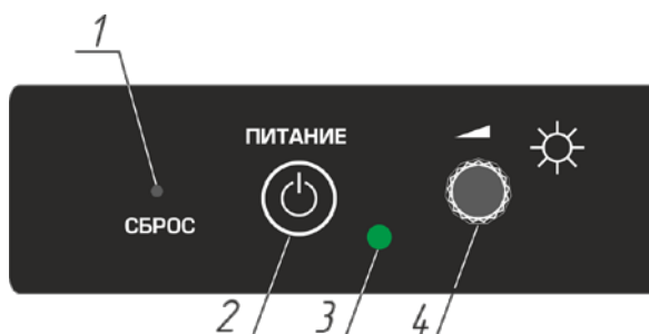
Рисунок 2 – Расположение органов управления и индикации на лицевой панели моноблоков с диагоналями экрана от 10” до 17”
