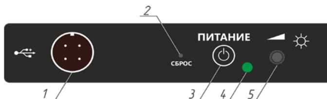
Рисунок 4 – Органы управления и индикации лицевой панели моноблоков с диагоналями экрана от 19” до 46”
