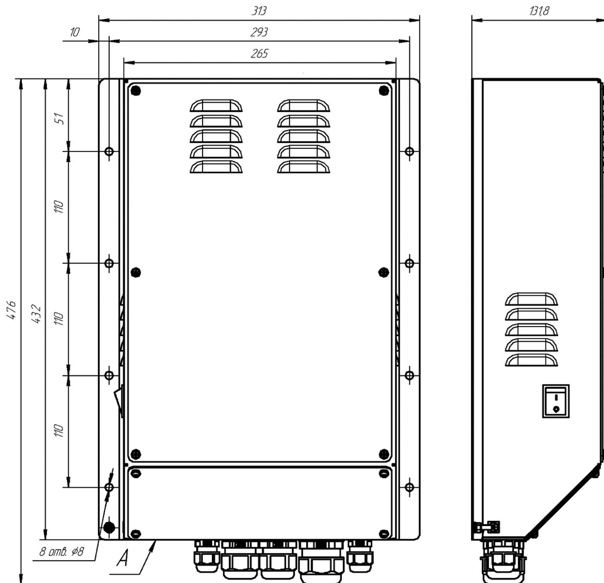
Рисунок Б.1 – Габаритные и установочные размеры изделия
