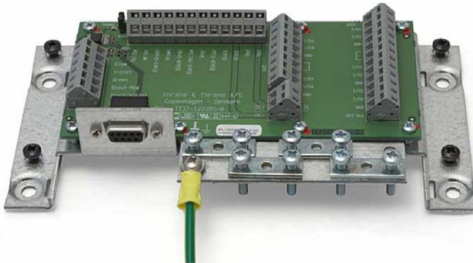
Рисунок 5. Крепление провода заземления к SCB-133.
