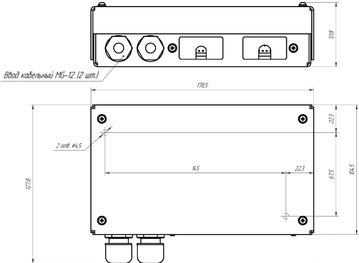
Рисунок А.1 – Габаритные и установочные размеры изделия
