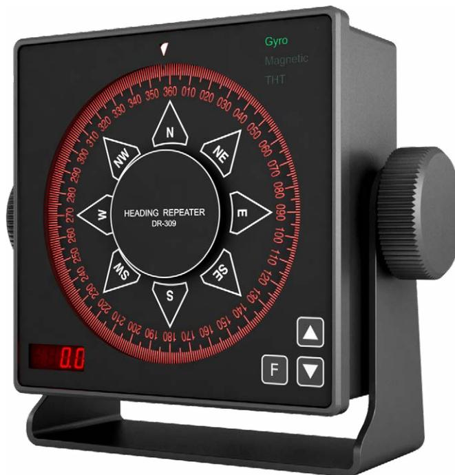
Путевой репитер ДР-309 предназначен для отображения информации о курсе судна, поступающей в формате NMEA предложений от различных цифровых источников, посредством картушечного указателя и светодиодного индикатора, а также для ретрансляции принятой информации в формате NMEA по каналу связи RS-422 (или CAN – опционально).
