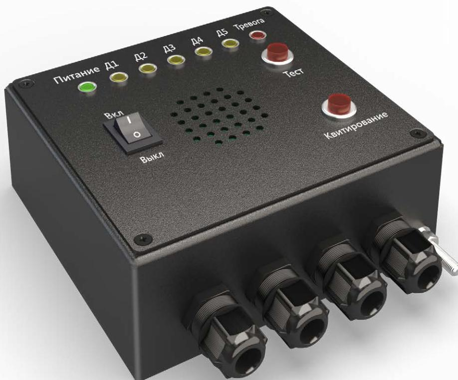
Блок сигнализации БС-206 предназначен для контроля срабатывания внешней сигнализации на пяти одновременно подключенных к нему устройствах, имеющих выход, основанный на замыкании/размыкании «сухих» контактов. Срабатывание сигнализации хотя бы на одном из входов вызывает подачу светозвукового оповещения и замыкание контактов «силового» выхода, к которому могут быть подключены внешние приборы сигнализации (лампы, звуковые оповещатели и пр.).
