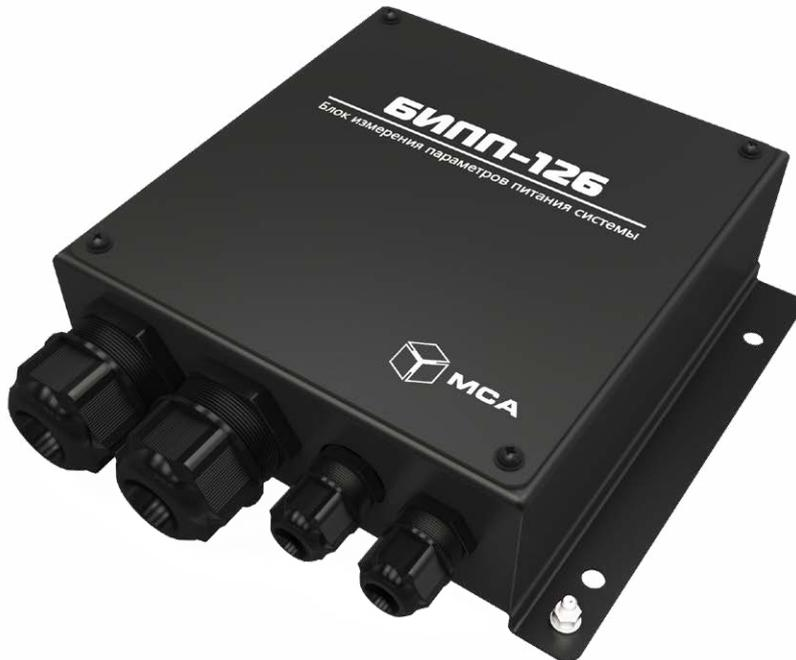
Блок измерения параметров питания системы БИПП-126 предназначен для снятия информации о значениях текущего напряжения и тока заряда аккумуляторной батареи. Позволяет осуществлять дистанционный контроль тока заряда/разряда и напряжения АКБ при использовании зарядных устройств сторонних производителей. Полученные данные ретранслируются на панель контроля аккумуляторных батарей ПКБ-136 по интерфейсу RS-422.
