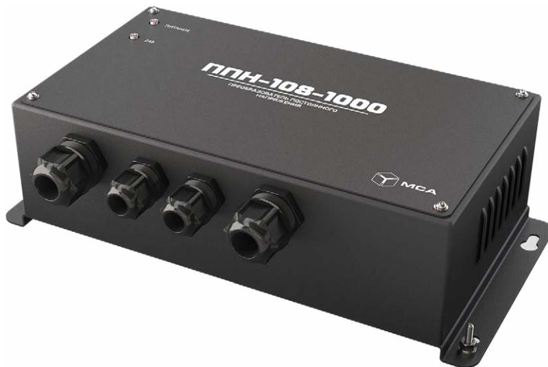
Преобразователь постоянного напряжения ППН-108-1000 предназначен для работы в сетях постоянного тока 24 В и служит для преобразования входного питающего напряжения в стабилизированное напряжение постоянного тока для питания оборудования различного назначения, чувствительного к перепадам питающего напряжения. Номинальная мощность устройства 960 Вт.
