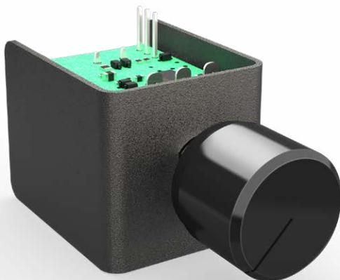
Диммер DM-107 – низковольтный регулятор мощности цепей постоянного тока, предназначен для плавной регулировки мощности нагрузки путем вращения потенциометра. Подключаемая нагрузка может иметь как резистивный (лампы освещения, резисторы), так и индуктивный (соленоиды, клапаны, двигатели) характер.
