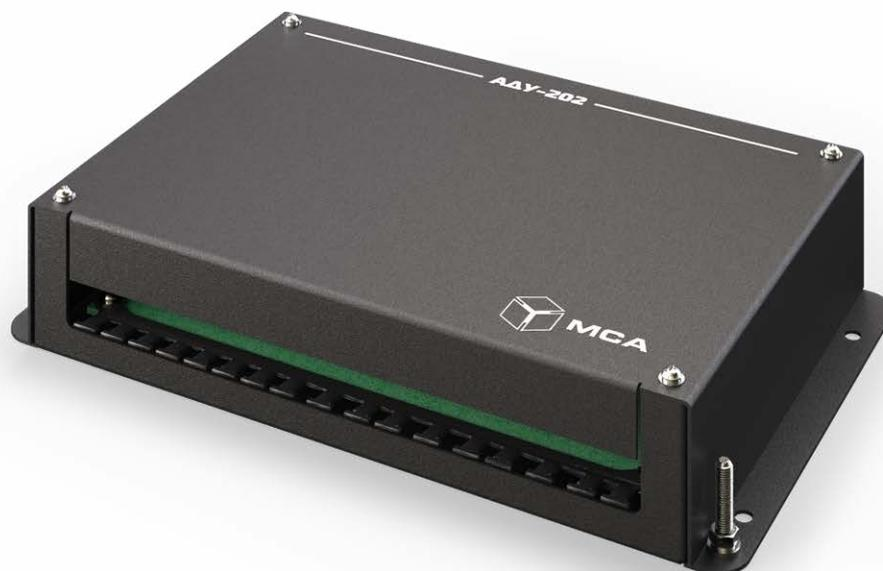
Устройство АДУ-202 предназначено для усиления и размножения сигналов NMEA 0183 версий 1 и 2, а также иных сигналов при последовательной передаче данных через интерфейсы RS-232 и RS-422/485. Кроме того, блок АДУ-202 имеет интегрированный сумматор, который позволяет комбинировать предложения NMEA 0183, получаемые по входным каналам, и передавать результат на одну или две группы выходов в зависимости от положения переключателей на печатной плате устройства.
