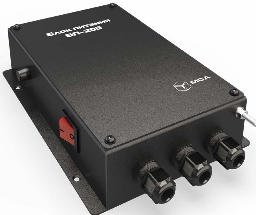
Блок питания БП-203 предназначен работы в однофазной сети переменного тока 50-60 Гц и служит для преобразования входного напряжения 110/220В переменного тока в стабилизированное напряжение 12/24/48В постоянного тока. Подходит для питания судового оборудования, чувствительного к перепадам входного напряжения.
