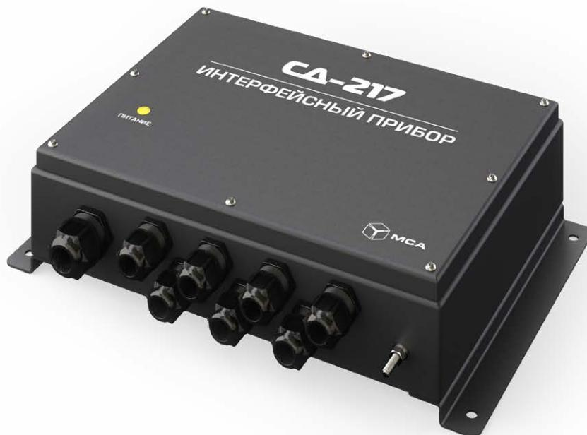
Сумматор данных СД-217 предназначен для приема сообщений от источников сигнала NMEA через 4 входных порта RS-232/422, суммирования и комбинирования полученных сообщений в соответствии с настройками пользователя и выдачи их через 12 выходных портов RS-232/422. Кроме перечисленных портов в устройстве предусмотрены 2 дополнительных служебных двунаправленных порта RS-232/422 и 1 USB.
