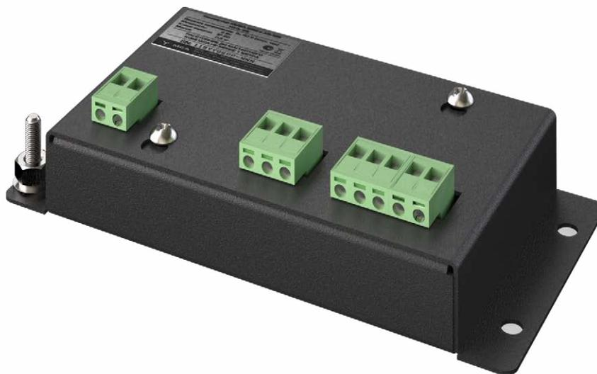
Устройство HTA-115 предназначено для преобразования значения курса, принимаемого в предложениях формата NMEA 0183, в сигналы формата AD-10S. HTA-115 используется для сопряжения устройств, не имеющих выхода AD-10S, с различным оборудованием производства компании Furuno.
