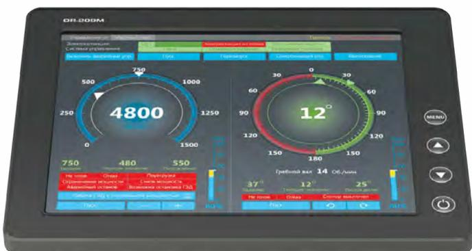
Местная панель управления ШПЛСУ оборудована сенсорным экраном резистивного типа с диагональю 8" производства «НПК Морсвязьавтоматика», а также стрелочными индикаторами мощности и оборотов ГЭД и электронным индикатором угла поворота ДРК.
