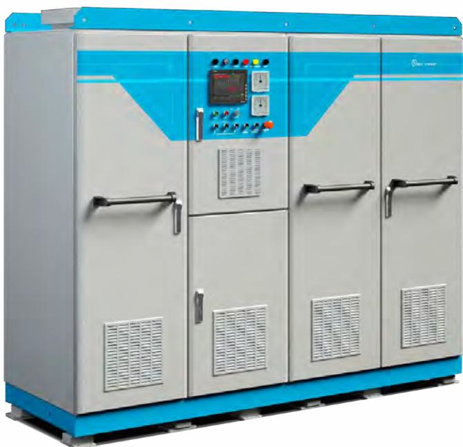
Принцип работы ПЧ - инвертор напряжения с широтно-импульсной модуляцией и активным выпрямителем на основе мощных IGBT-транзисторов. В роли транзисторов используются силовые инверторные сборки, обладающие повышенной стойкостью к жестким условиям окружающей среды и термоциклированию.
