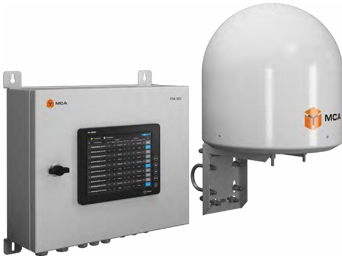
СОА-1022 обеспечивает автоматический обогрев антенн, устанавливаемых на открытой палубе для защиты их от воздействия низких температур. Обогрев осуществляется посредством ПОА (прибор обогрева антенны): радиопрозрачных теплоизолирующих куполов с установленными внутри нагревателями и датчиками температуры.
