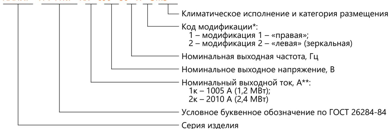
\* Код модификации вводится для обозначения модификации конструкции ПЧ в зависимости от расположения секций шкафов друг относительно друга.
