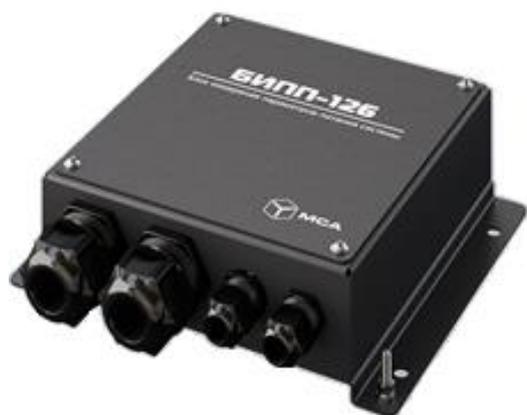
Блок измерения параметров питания системы БИПП-126 (BMU-126) предназначен для снятия информации о значениях текущего тока и напряжения цепи, в которую установлено изделие, и трансляции этой информации по интерфейсу RS-422 на панель контроля состояния аккумуляторных батарей ПКБ-136 (ПКБ-136-01) или другие соответствующим цифровым потребителям.
