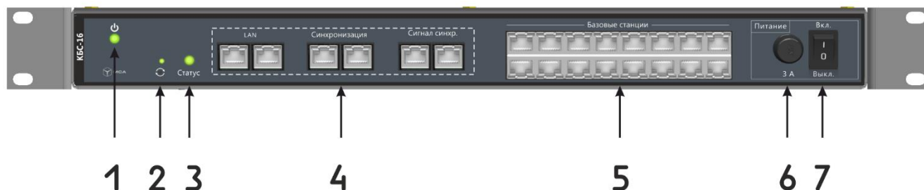
Рисунок 48 – Расположение и обозначение органов управления и индикации КБС-16
