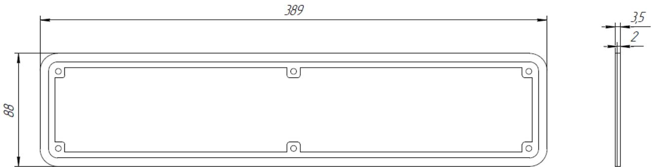
Рисунок 8 . Габаритные размеры рамки панели кнопок для пультавого монтажа.
