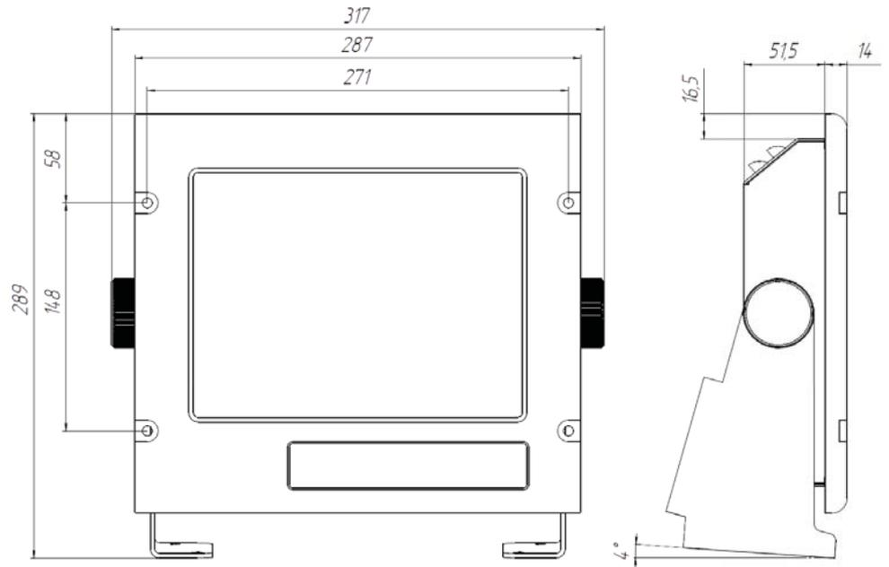
Габаритные и установочные размеры MV-1004
