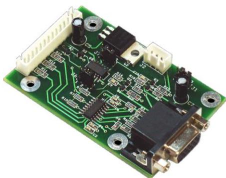
VGA-интерфейс ДВС-119 (для радаров РДР, У-РДР) предназначен для подключения сигналов VGA радаров и иных составных частей или оборудования к РДР и У-РДР. ДВС-119 обеспечивает усиление и фильтрацию от помех сигнала VGA.
