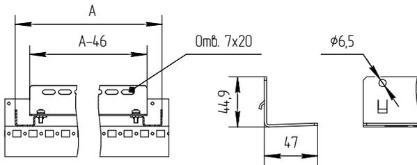
Для поддержки тяжелого 19" оборудования. Легко навешивается и закрепляется. Устанавливается по глубине между вертикальными профилями.
