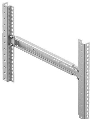
Бесступенчатый конструктив позволяет устанавливать профили в диапазоне от 455 до 655 мм с шагом 25 мм между монтажными плоскостями стоек под 19" оборудование. Используется для установки выдвижных полок и выдвижных вентиляторных блоков для 19" оборудования.
