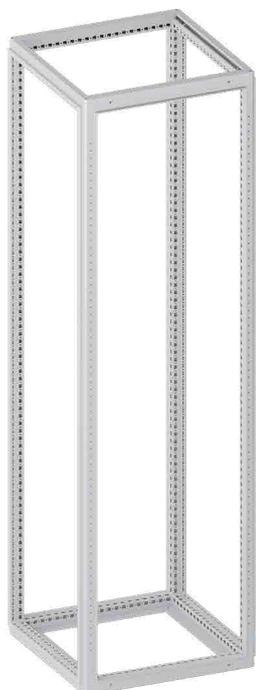
Каркас ШНС-КС PRO для сборки шкафа по индивидуальным требованиям в зависимости от формы секционирования. Сверху предусмотрены глухие отверстия с резьбой M12 для установки рым-болтов. Для крепления цоколя — сквозные отверстия диаметром 14 мм. На лицевой поверхности передних стоек каркаса предусмотрены отверстия M5 для монтажа секционных дверей. Отверстие в основании закрывается сплошными панелями.
