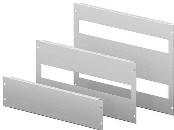
Для установки на вертикальный профиль под модульное оборудование с шагом 50мм. Крепится винтами М6 в закладные гайки М6 (в комплект не входят). Вырезы предназначены для модульного оборудования.
