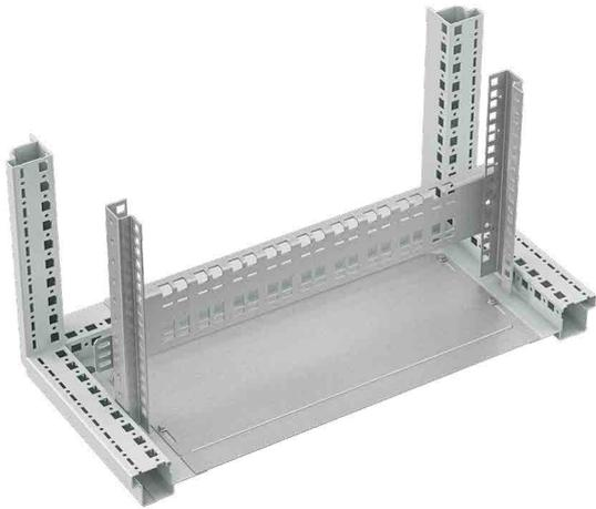
Для разводки кабелей. Устанавливается непосредственно на каркас/ на профиль под 19" оборудование/ на кронштейн С-образного профиля. Крепится на резьбовыдавливающие винты М5 (в комплект не входят).
