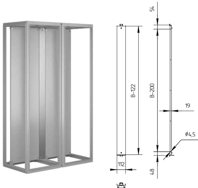
Для создания единой монтажной поверхности двух шкафов. Установка между МП на кронштейны. Дополнительно можно зафиксировать с задней стороны к панели с помощью резьбовыдавливающих винтов М5 (в комплект не входят).
