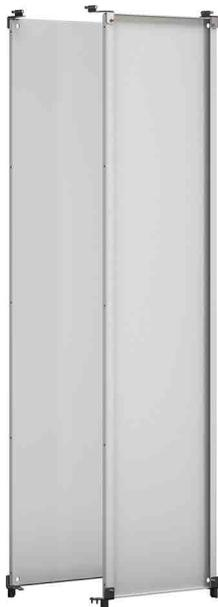
Для монтажа во всю высоту внутри распределительного шкафа. Крепится через кронштейны винтами М6 с внутренним шестигранником с шагом 25 мм по глубине шкафа.
