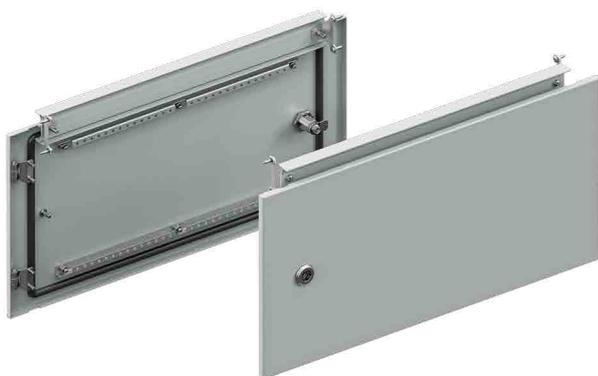
Крепится на стойки каркаса. Возможны и левая, и правая установки. При использовании секционных дверей данного типа сверху и снизу корпуса необходимо установить заглушки. В комплект входит секционная перемычка и рейки для установки дополнительного оборудования и прокладки кабель-каналов. Дверь оснащена поворотным замком под ключ с двойной бородкой 5 мм (возможна замена).
