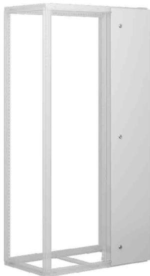
Устанавливается во всю высоту. Возможна как левая, так и правая установка. Дверь используется в случае, когда шкаф разделен на секции с помощью вертикального разделителя (см. выше). Дверь оснащена поворотным замком под ключ с двойной бородкой 5 мм (возможна замена).
