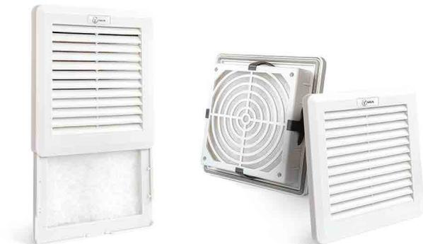
Для охлаждения оборудования в электротехнических шкафах. Легко защёлкивается в монтажный проём, дополнительное крепление винтами не требуется. Сменные фильтры устанавливаются снаружи шкафа, Степень защиты при этом не нарушается.
