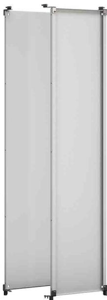
Для монтажа во всю высоту внутри распределительного шкафа. Крепится через кронштейны винтами М6 с внутренним шестигранником с шагом 25 мм по глубине шкафа.
